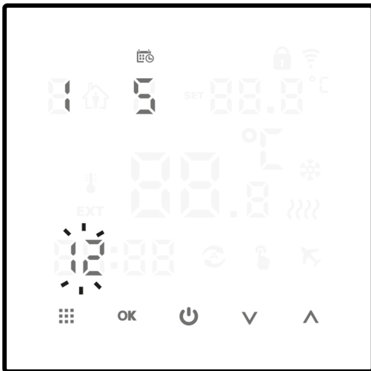
Pomocí tlačítek (□□) vyberte hodinu spuštění programu a poté přejděte k nastavení minuty startu opětovným stisknutím tlačítka (□).
