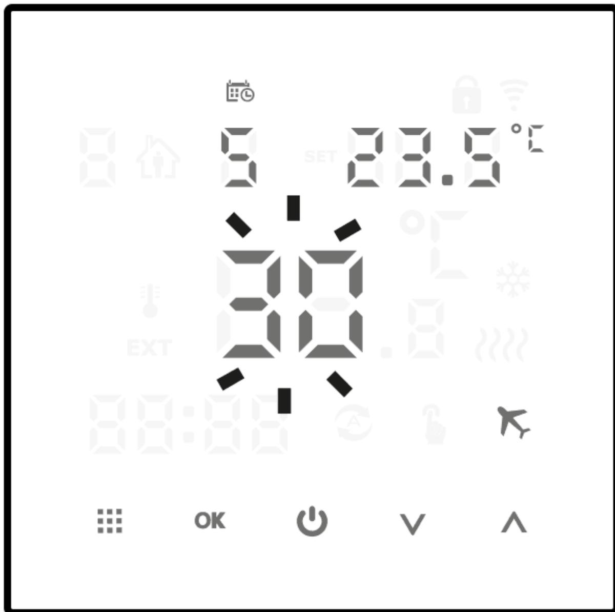
4. Poté nastavte požadovanou teplotu pomocí tlačítek (↑↓).
