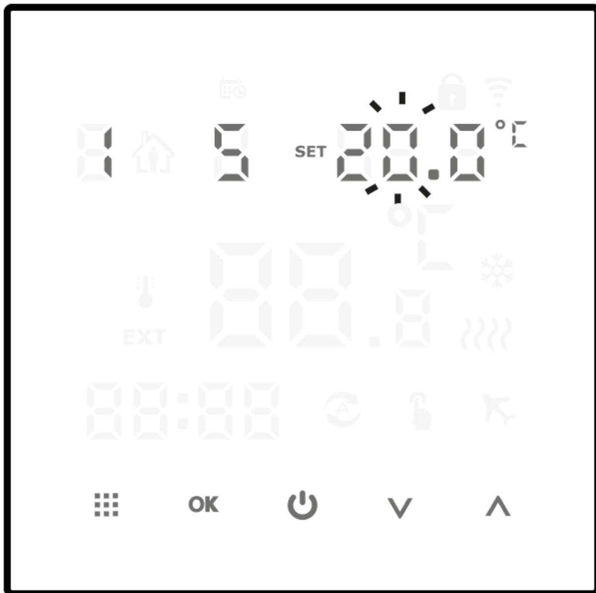
Pomocí tlačítek (□) vyberte teplotu programu a poté přejděte k nastavení dalšího programu stisknutím tlačítka (□).
