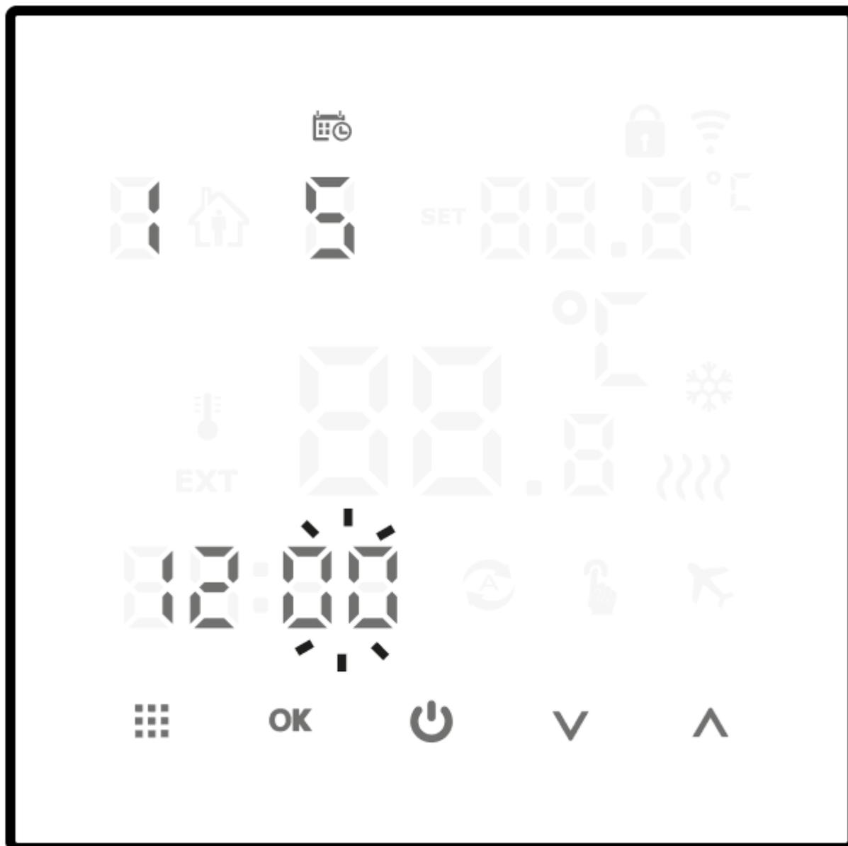
Pomocí tlačítek (□□) vyberte minutu spuštění programu a poté přejděte k nastavení teploty stisknutím tlačítka (□).
