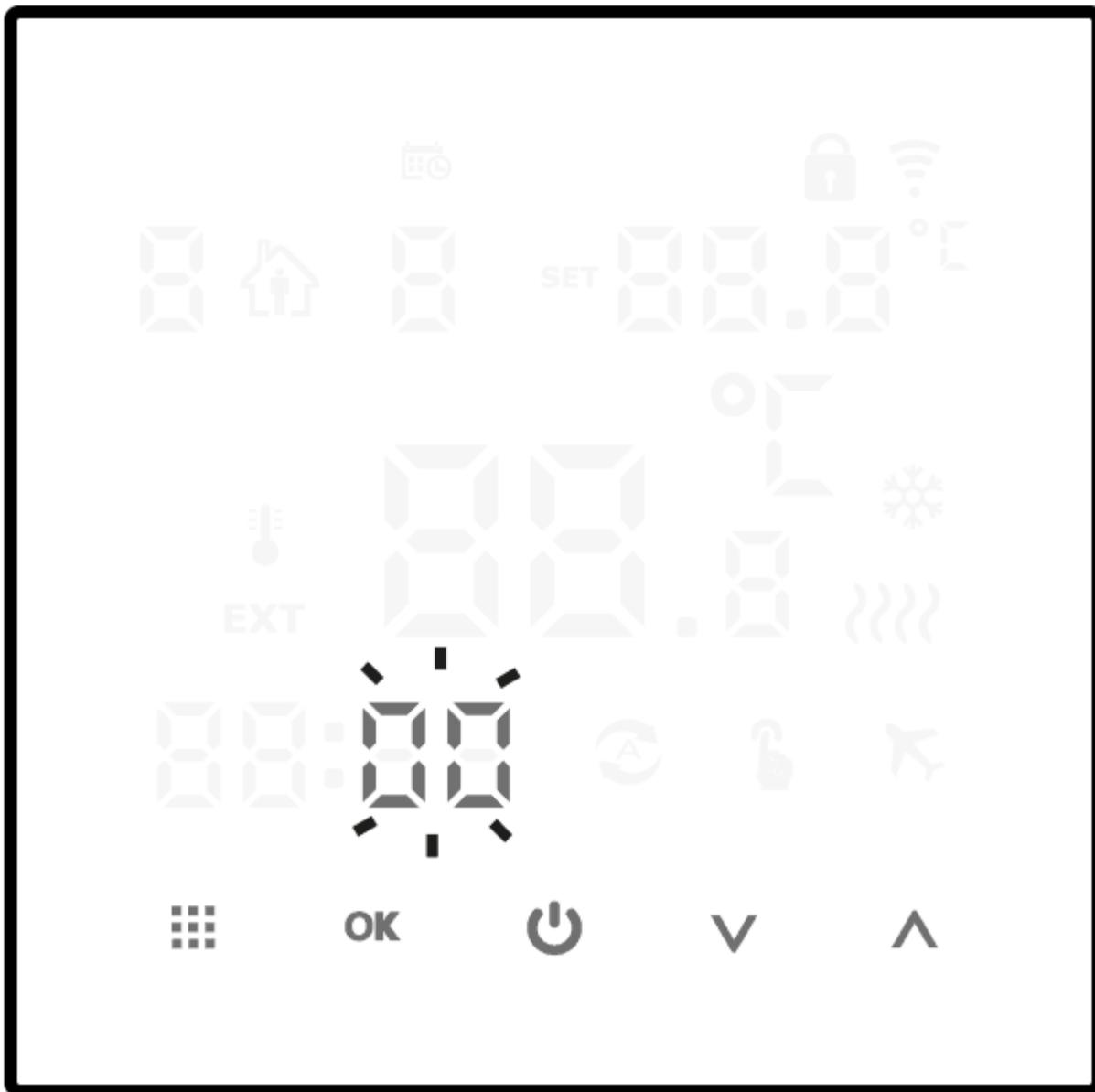
2. Pomocí funkčních tlačítek (⬇️) nastavte požadovanou minutu a potvrďte tlačítkem (OK).
