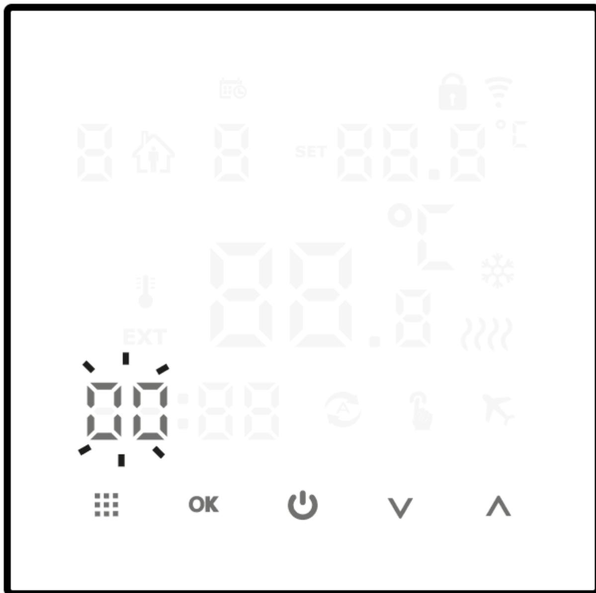
4. V levém horním rohu displeje se zobrazí blikající symbol dne týdne. Pomocí funkčních tlačítek (☐) nastavte požadovaný den týdne a potvrďte tlačítkem (☐).
