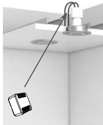
montáž do podhledu
