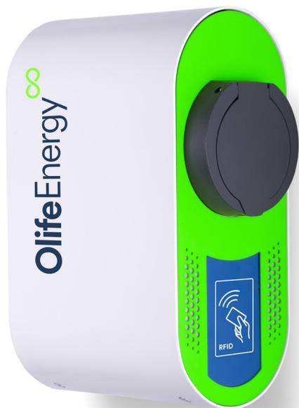
OlifeEnergy WallBox je celokovová odolná dobíjecí stanice pro nabíjení všech elektromobilů střídavým proudem (AC), výkonem až 22 kW. Určena je pro vnitřní i venkovní použití, s možností montáže na zeď nebo na profil, kotvený do země (sloupek). WallBox může být vybaven dle přání zákazníka zásuvkou nebo kabelem (Type 2 i Type 1), případně speciálním krouceným kabelem.
