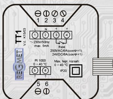
Svorky 1 a 2..... napájení přístroje 230 V / 50 Hz
