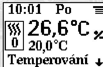
Ve výchozím stavu je termostat nastaven jako prostorový v módě vytápění s PI regulací, s periodou PI regulace 10min a v režimu Temperování na 20°C. To znamená, že měří pouze interiérovou teplotu a reguluje ji na 20°C bez časových profilů.
