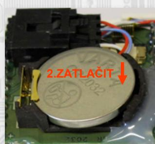
Vyjmutí zálohovací baterie (obr. 8):
