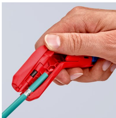
Odizolování datového kabelu
