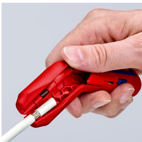
Odizolování koaxiálního kabelu
