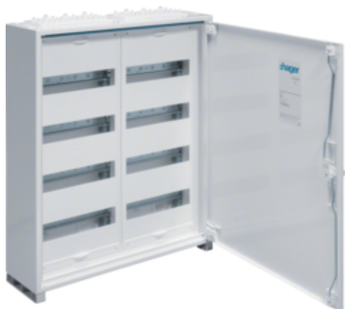
Rozvaděč nástěnný FW, IP44, tř. ochr.II, 96 mod., 650x550x161
