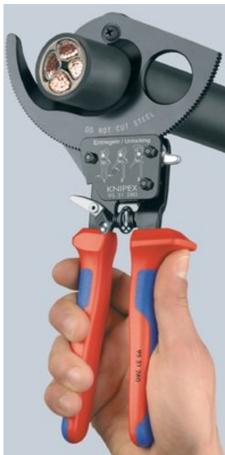
Princip rohatky se západkou a dvoustupňový pohon ozubeným věncem pro stříhání šetřící síly
